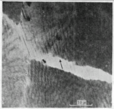
图 14 拉伸过程中的球晶边界
